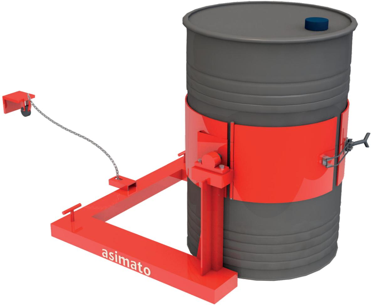
5 galonluk çelik varil ve 210 litrelik plastik varillerin taşınması ve varildeki malzemenin 360 derece döndürülerek boşaltılması için kullanılır. Sadece forklift ile kullanılabilir. Yağ tamburlu 360 derece dönebilen dönüş aparatı sayesinde yoğun çalışma sürelerinde maksimum performans sağlar.
